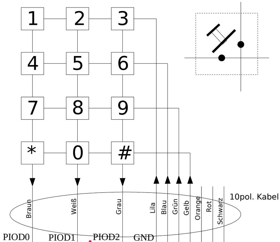
Es wird die Lila-Leitung mit GND verbunden. Braun, Weiß und Grau werden mit PIOD0, PIOD1 und PIOD2 des Arduino DUE verbunden. Somit können die Tastendrucke der Tasten 1, 2 und 3 ausgewertet werden. Es könnte auch die komplette Tastatur genutzt werden. Hierzu müssten dafür auch alle weiteren Anschlüsse an das DUE geführt werden. Die Tasten ziehen beim Drücken das Potential auf GND. Beim Initialisieren der genutzten Eingänge ist PullUp zu aktivieren.
