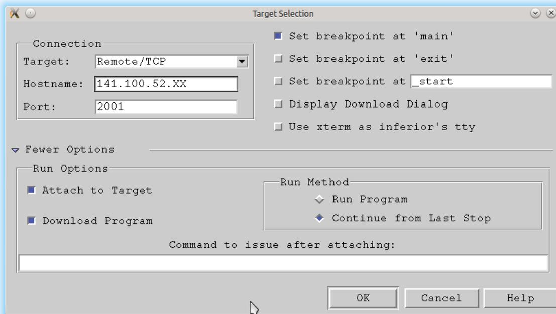
niert, wenn aus dem Laufflicht der Dioden ein statisches Leuchten der rechten 3 LED wurde. Wählen Sie für den Hostname die IP-Adresse, welche auf dem zugehörigen BDI2000 steht. Als Port wählen Sie die 2001. Weitere Einstellungen entnehmen Sie der folgenden Abbildung.
