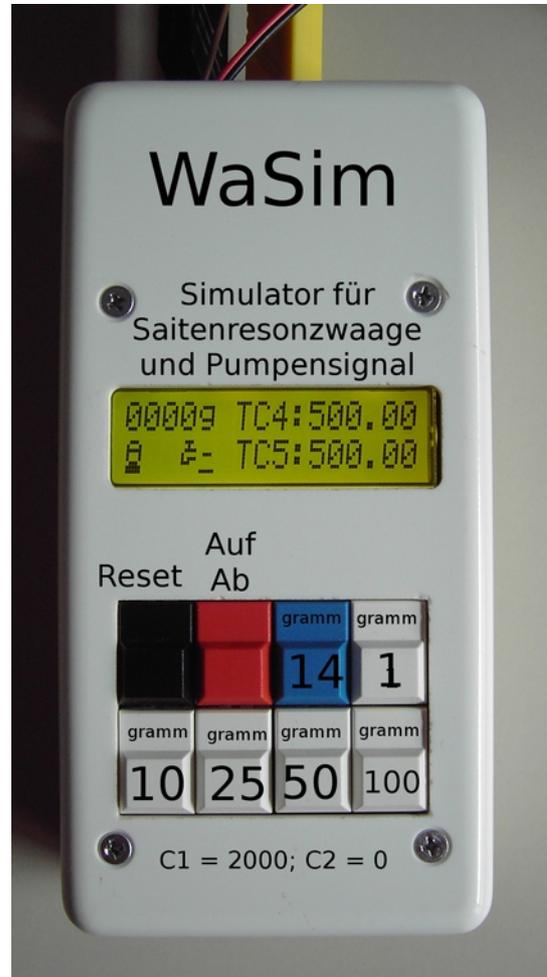
Berechnen Sie die Masse  $m$  aus den zu erfassenden/messenden und gegebenen Werten. Setzen Sie für C1 und für C2 die für die Waage angegebenen Werte ein.
