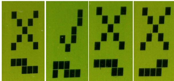
*Frequenz zu niedrig*    *Frequenz richtig*    *Highpegel zu lang*    *Lowpegel zu lang*
