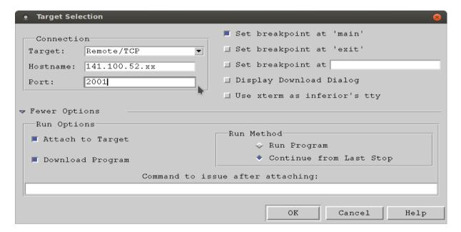
"Set breakpoint at exit" sollte noch ausgeschaltet werden. Es gibt bei der für das Board gebauten Software kein Label "exit".
