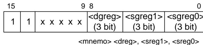
Bild 4.7: Codierungsformat für 3-Register-Befehle
