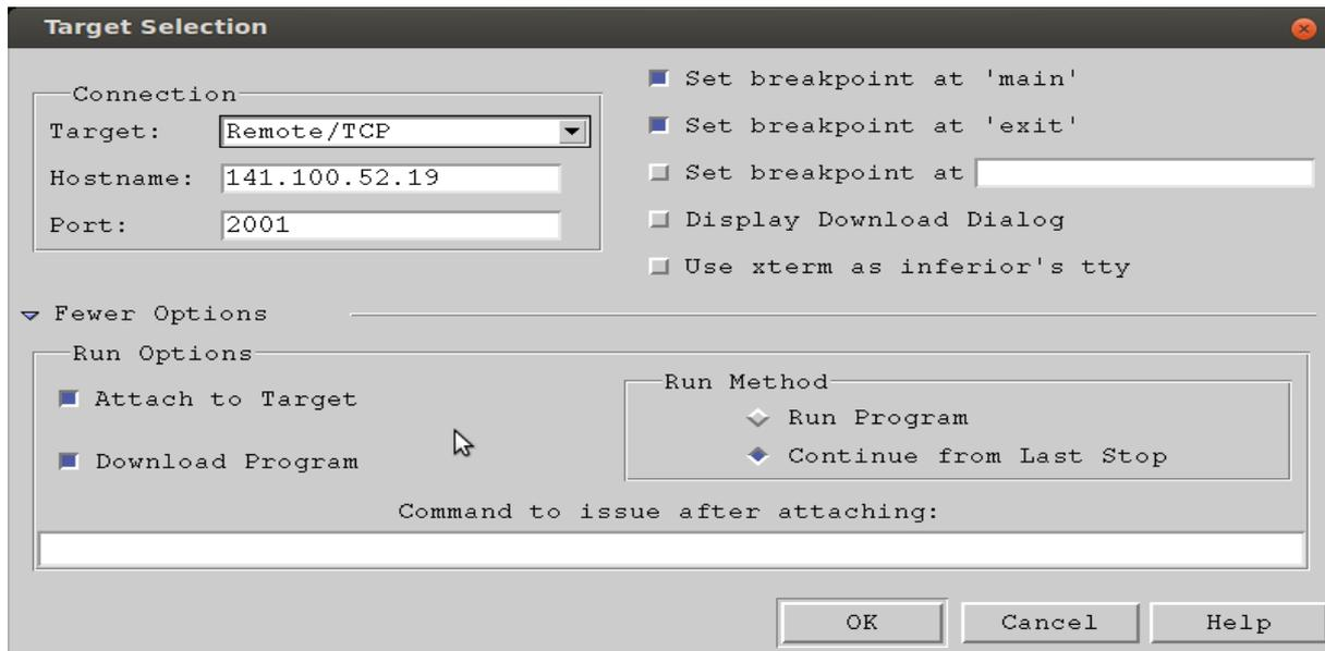
„Set breakpoint at exit“ sollte noch ausgeschaltet werden. Es gibt beim make für das Board kein Label „exit“.
